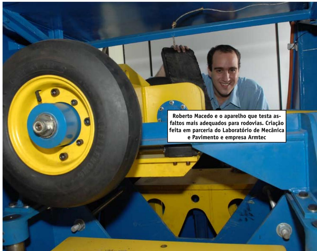
**Roberto Macedo e o aparelho que testa asfalto mais adequados para rodovias. Criação feita em parceria do Laboratório de Mecânica e Pavimento e empresa Armtec**
