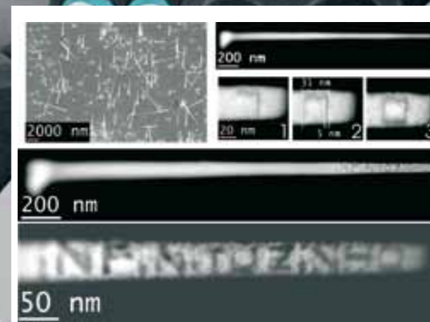
Escrita sobre nanofio de índio, visualizado em microscópio eletrônico
